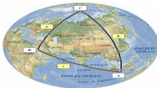
Gambar 5 Prinsip perhitungan sudut di atas segitiga bola.
