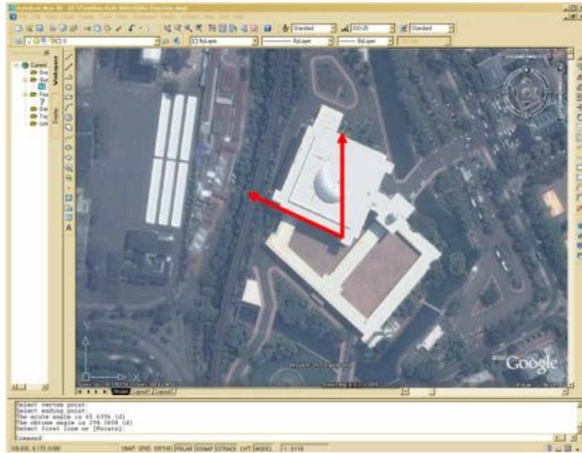
Gambar 10. Citra satelit dari Masjid Istiqlal, serta pengukuran sudut dengan software AutoDesk Map (AutoCAD).
