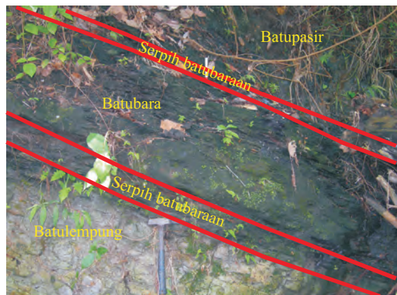
Gambar 10. Potret lapisan batubara dengan tudung dan lantai batulempung; kontak dengan batubara dibatasi oleh serpih batubaraan.
