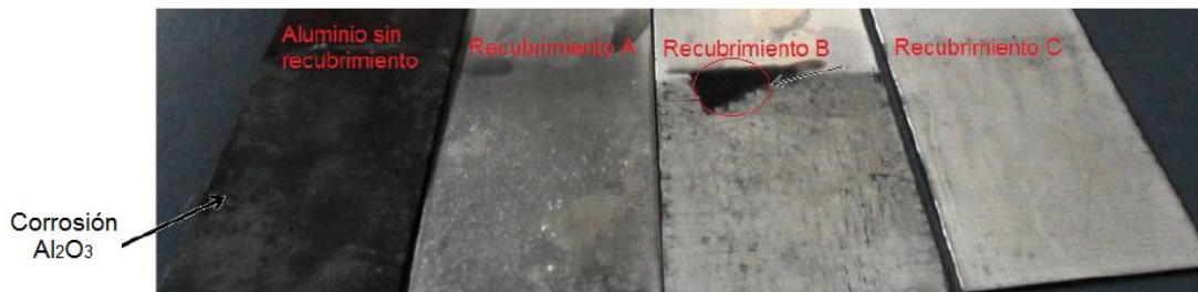
Fig. 7. Aluminio después de realizar el ensayo de corrosión.
