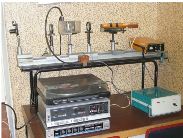
Рис. 7. Установка для передачи музыки по лазерному лучу
