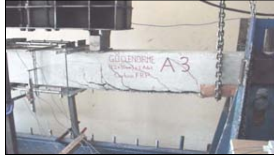
Şekil 4. FRP plaka ile güçlendirme, kiriş-kesme çatlakları ve pas payının kopması
