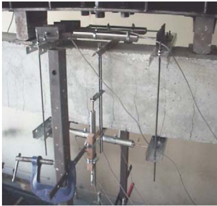
Şekil 1. Yalın kiriş eğilme-çekme çatlakları
