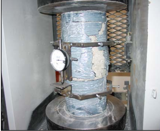
Şekil 2. CFRP ile sarılmış silindir numune testi
