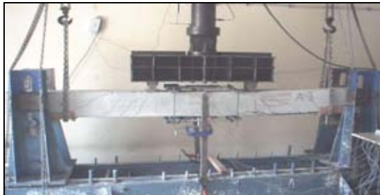
Şekil 3. FRP plaka ile güçlendirme, kiriş son durumu
