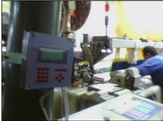
Şekil 8. Dokuma salonu veri alma sistemi örneği.
