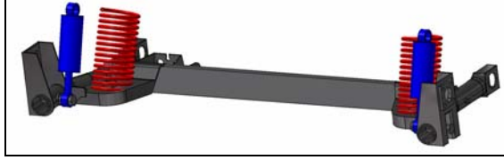
Şekil 2: Dingil üzerinde yer alan süspansiyon elemanları.
