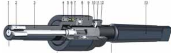
1. Konik mil; 2. Ezme bilyesi; 3. Kafes; 4. Kovan kapağı; 5. Rondelâ; 6. Yay; 7. Rondelâ; 8. Rulman; 9. Kovan; 10. Ayar dişlisi; 11. Pim; 12. Kontra somunu; 13. Sap.
