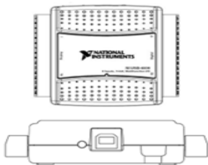
Рис. 3. Устройство сбора данных (УСД) National Instruments USB-6008
