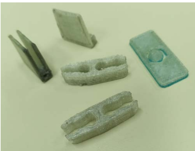
Fig. 14. Muestras de pequeñas piezas impresas con filamento PET reciclado.
