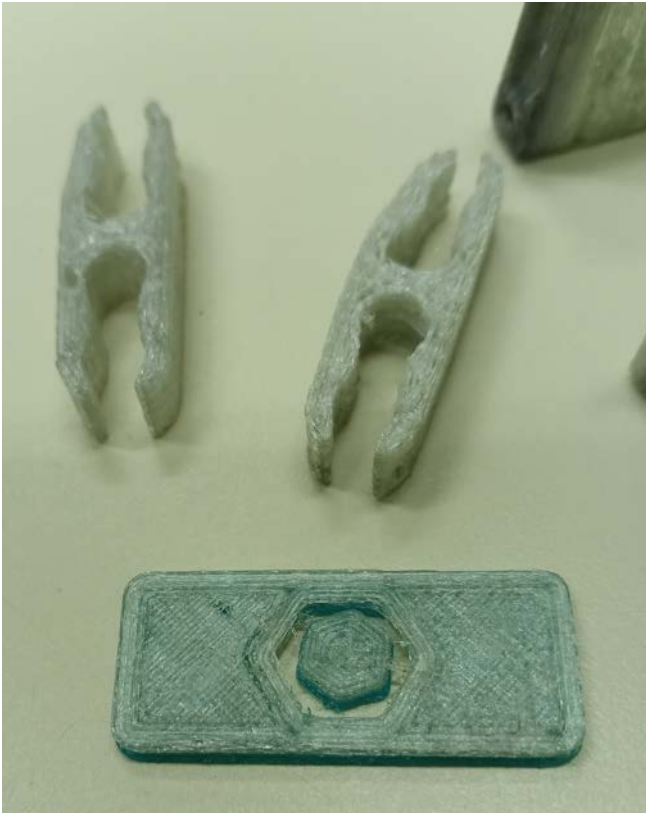
Fig. 13. Muestras de pequeñas piezas impresas con filamento PET reciclado.
