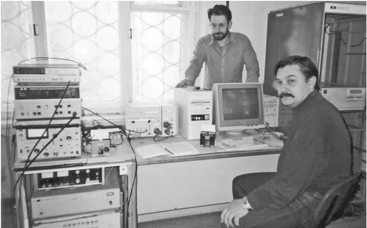
Рис. 31. Д. В. Шалунов (ліворуч) і С. В. Стьопкін за роботою на 4096-канальному цифровому кореляційному спектроаналізаторі [14]
