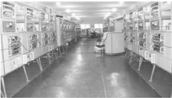
Рис. 37. Обчислювально-керуючий комплекс АСВТ М-6000 (використовувався з початку 70-х років до середини 90-х як перша головна комп'ютерна система для управління телескопом, цифрової реєстрації сигналів і обробки даних)
