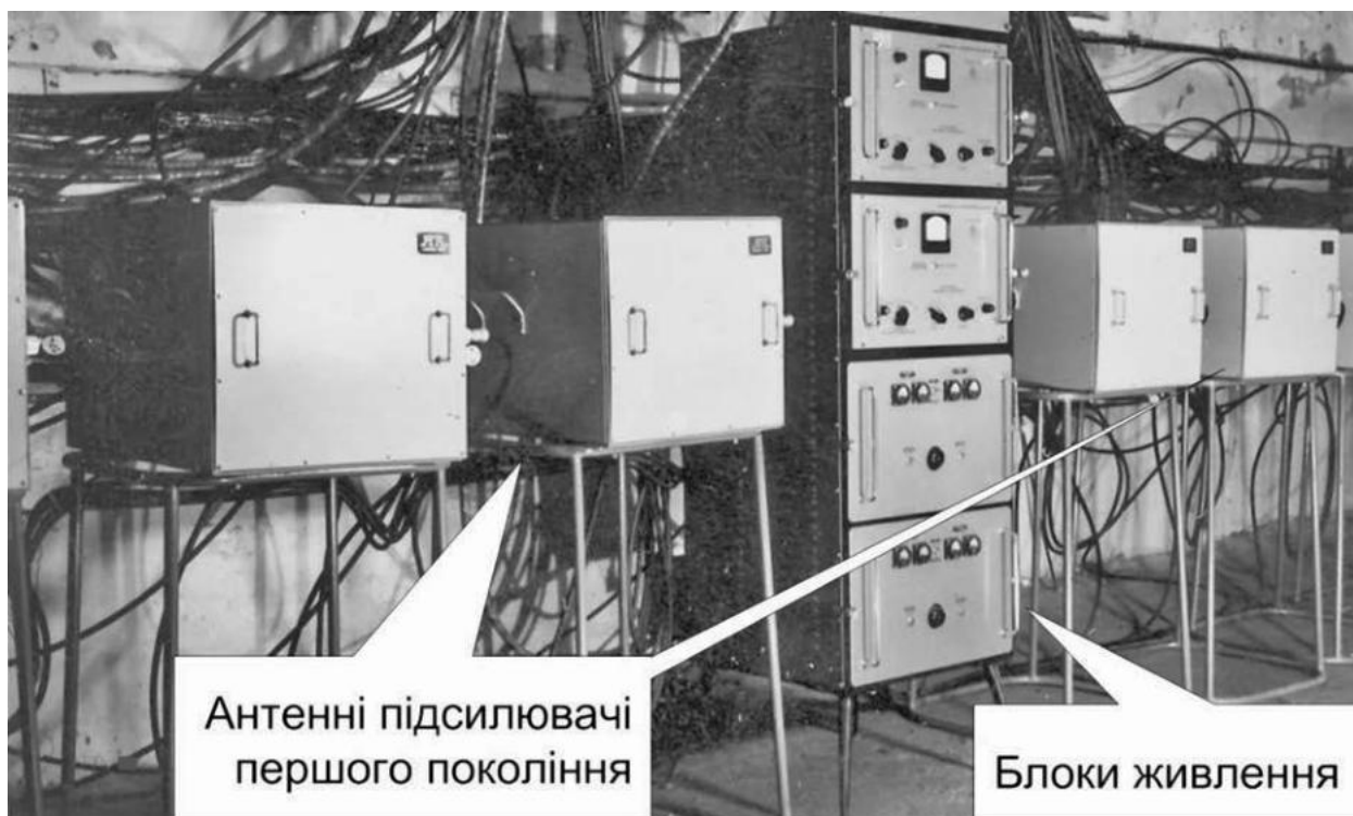
Рис. 10. Антенні підсилювачі другого ярусу радіотелескопа УТР-2 розробки початку 70-х років
