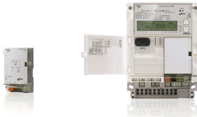
Slika 9. Često korišćeno brojilo električne energije kojim se postižu važne radne osobine u oblastima industrijske i komercijalne primene. Proizvodi se za klase 0,2 S i 0,5 S za aktivnu električnu energiju i sa osmofarskim ekranom [9]. Na levoj strani slike prikazan je izvlačivi modem
