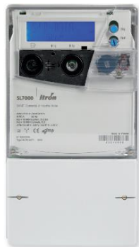
Slika 1. Često korišćeno brojilo električne energije u industriji i transformatorskim stanicama i razvodnim postrojenjima, klase 0, 2 S ili 0, 5 S za aktivnu električnu energiju sa devetocifarskim ekranom, koje se pravi za konstantu 10000 imp./kWh za brojila za indirektni priključak preko mernih transformatora [5].
