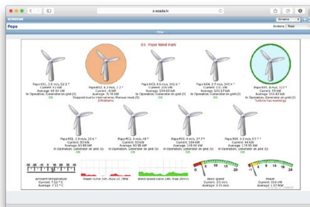
Slika 5. Z-SCADA monitoring sistem za vjetrogeneratore
