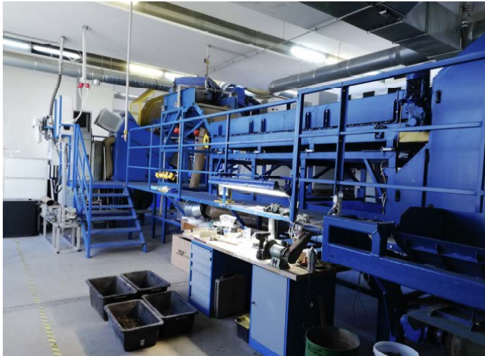
Slika 6. Poluindustrijsko postrojenje za X-Ray senzorsko sortiranje
