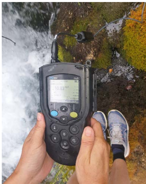
Slika 1. Određivanje sadržaja koncentracije rastvorenog kiseonika na licu mesta duž reke Komarnice
