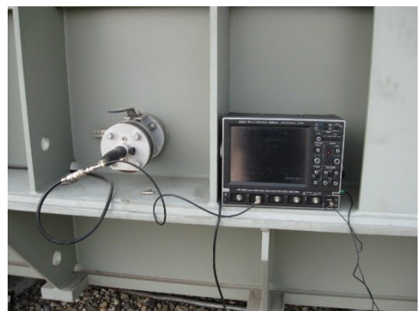
Slika 9 – Merna oprema korišćena prilikom izvođenja ogleda otkrivanja parcijalnih pražnjenja.
