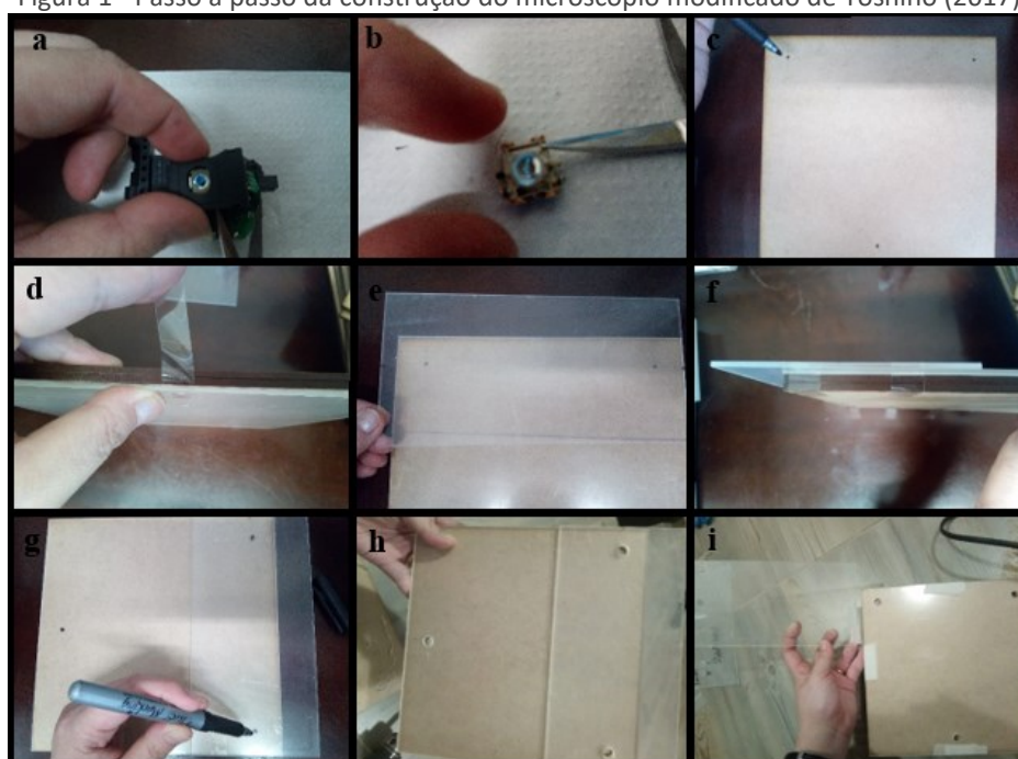
Figura 1 - Passo a passo da construção do microscópio modificado de Yoshino (2017)
