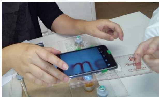
Figura 3 - Smartphone sendo ajustado sobre o aparador de acrílico e objeto (régua) sendo colocado no suporte para lâminas (placa retangular intermediária)
