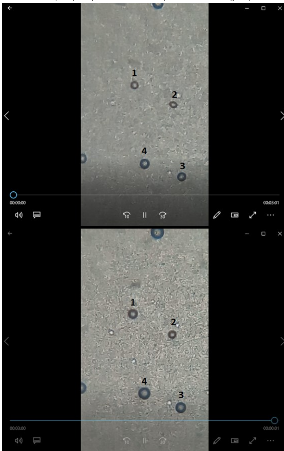
Figura 10 - Avaliação do aumento do diâmetro das bolhas de gás produzidas por suspensão aquosa de leveduras sem adição de açúcar em microscópio modificado de Yoshino (2017) com prints de telas nos tempos 0 e 3 minutos de gravação
