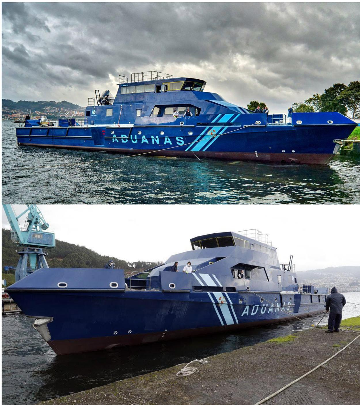
**Рис. 2.** Катер на воде в ожидании достройки и вооружения
