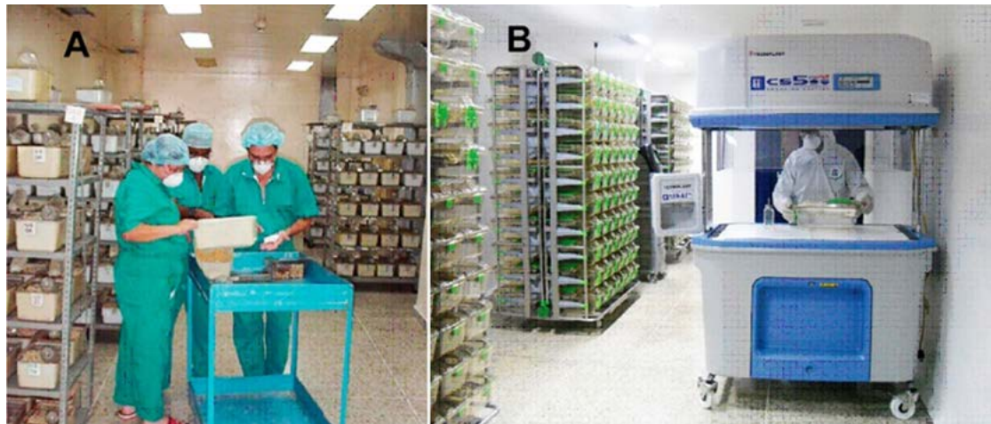
Figura 6. Área de Producción. A: antes de la remodelación y B: después de la remodelación, racks ventilados y campana de flujo laminar CS5
