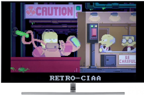
Fig. 10. Video por streaming desde tarjeta microSD y transcoding de 24 a 60 cuadros por segundo en el núcleo Cortex-M4F mientras el Cortex-M0 genera la señal de video.
