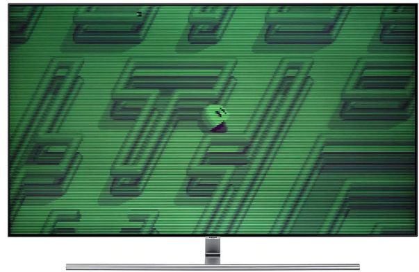
Fig. 12. Efectos aplicados «al vuelo» por el núcleo Cortex-M0 mientras genera la señal de video: scanlines de monitor CRT y filtros de color a pantalla completa.
