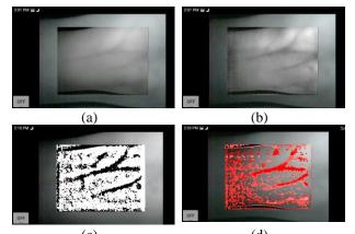
(c) (d) Figure. 7 Sample results for a wrist: (a) grayscale frame (b) applying contrast enhancement CLAHE (c) adaptive thresholding, and (d) color veins
