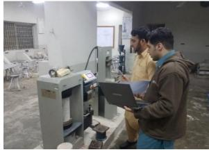
FIG. 1. CARRYING OUT COMPRESSION TEST
