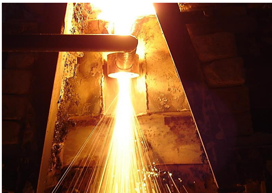
Рисунок 2. Расщепление базальтового расплава в волокно.
