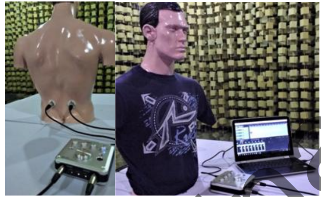
Fig. 5. Conexión entre HATS, placa de sonido y computadora.
