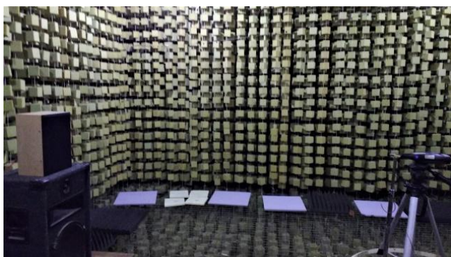
Fig. 9. Verificación de la rutina de medición de presión sonora y calibración del sistema.
