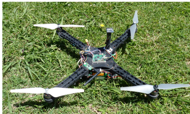
Figura 4. UAV utilizado para la validación experimental del autopiloto.
