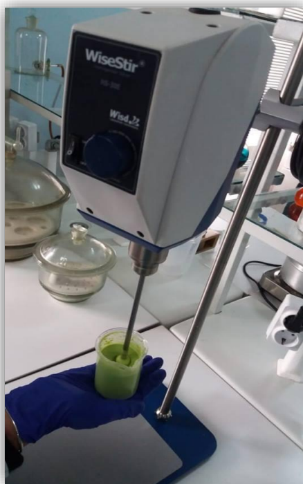
Рис. 2. Гомогенизация смеси на гомогенизаторе WiseStir Homogenizer Stirrer HS-30E
