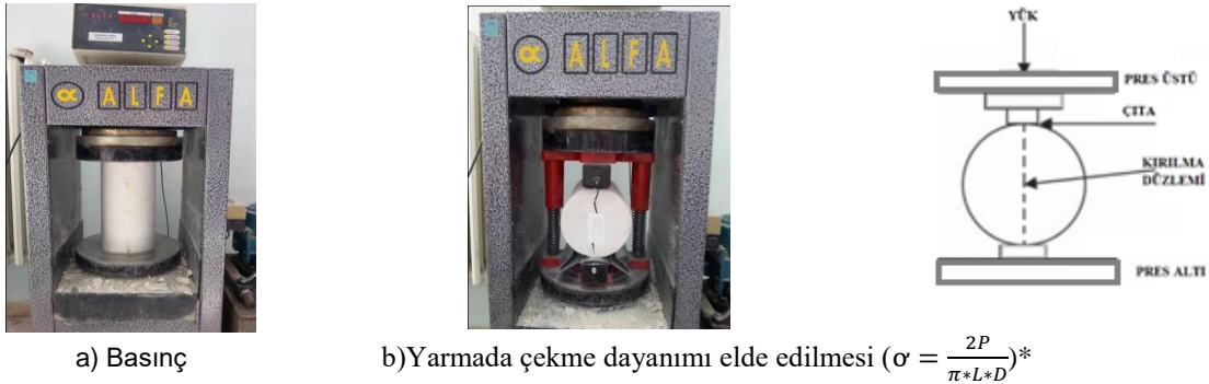
Şekil 9: Yangın sonrası numunelerin basınç ve yarmada çekme testleri (*Denklemdede P kırılma sırasında ölçülen basınç yükü, L silindirin yüksekliği D ise silindirin çapını göstermektedir)
