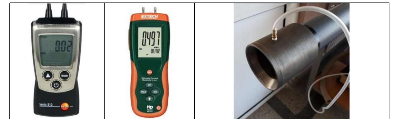
**Фиг.3. Измервателни устройства – манометри и дебитомер**
