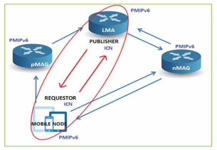
FIG. 1. BASIC NETWORK MODEL FOR PMIPV6 AND ICN
