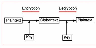
FIG. 1. MODEL FOR CRYPTOGRAPHY
