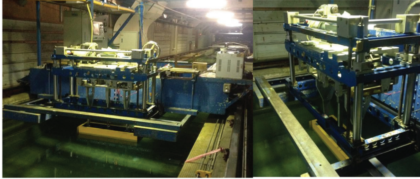
Şekil 5. Çekme Tankı ve Zorlayıcı Yalpa Deney Mekanizması
