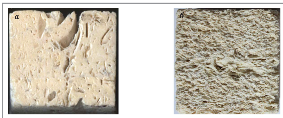
Рис. 1. Структура образцов известняка-ракушечника: а – Россия (Бурлацкое месторождение); б – Казахстан (Жетыбайское месторождение)
