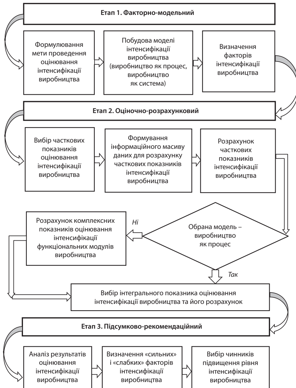
Рис. 1. Етапи застосування методу інтегрально-модельного оцінювання інтенсифікації виробництва
