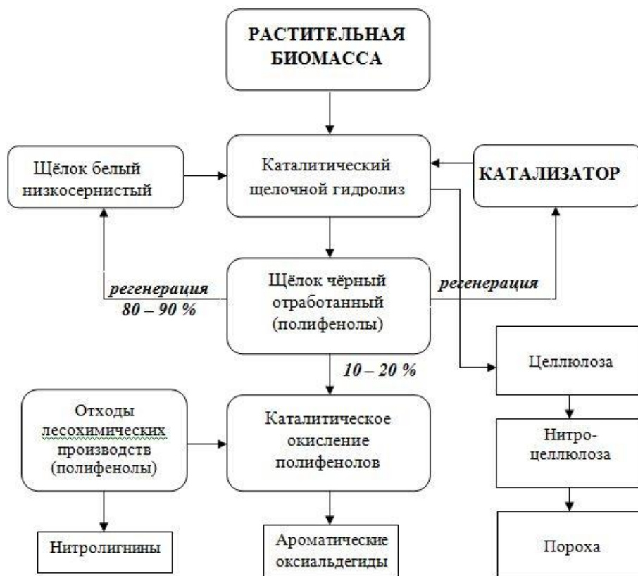
Схема комплексной переработки растительной биомассы
