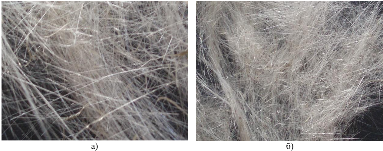
Рисунок 3. Микрофотографии минеральных волокон полученных путем раздува струи расплава имеющей температуру 1700 °С: а — волокна из отходов горючих сланцев ( d=7 мкм), б — волокна из золоотходов ( d=4 мкм). Увеличение \times 300
