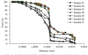
FIG. 1. PARTICLE SIZE DISTRIBUTION CURVES FOR ALL SOIL SAMPLES
