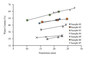
FIG. 2. LIQUID LIMIT CURVES FOR ALL SOIL SAMPLES
