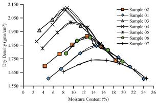
FIG. 3. COMPACTION CURVES FOR ALL SOIL SAMPLES
