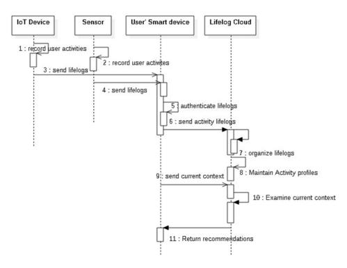
FIG. 2. SEQUENCE DIAGRAM OF THE SYSTEM
