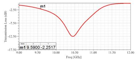
FIG. 10. TRANSMISSION LOSS OF E-FIELD VERSUS FREQUENCY OF DUAL LAYER POLARIZER
