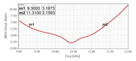
FIG. 12. THE AXIAL RATIO BANDWIDTH VERSUS FREQUENCY OF DUAL LAYER POLARIZER
