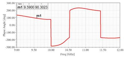
FIG. 11. PHASE DIFFERENCE OF E-FIELD VERSUS FREQUENCY OF DUAL LAYER POLARIZER
