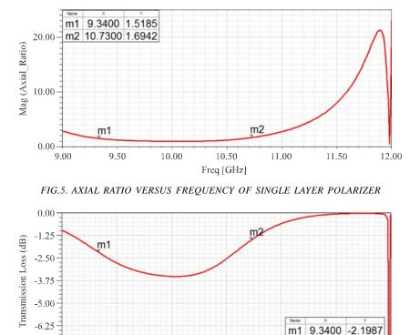
FIG.6. TRANSMISSION LOSS OF E-FIELD VERSUS FREQUENCY OF SINGLE LAYER POLARIZER IS OBTAINED UNDER THE NORMAL INCIDENCE OF X-LINEARLY POLARIZED WAVE
