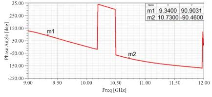
FIG.7. PHASE DIFFERENCE OF E-FIELD VERSUS FREQUENCY OF SINGLE POLARIZER
