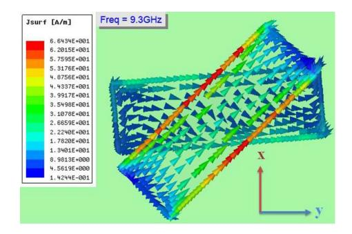
FIG. 13. THE TRANSMISSION ORGINATES FROM RESOANCE FROM DOUBLE-LAYER CIRCULAR POLARIZER
