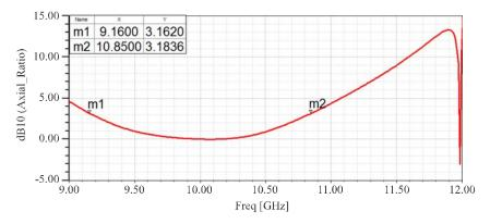
FIG. 8.THE AXIAL RATIO BANDWIDTH VERSUS FREQUENCY OF SINGLE LAYER POLARIZER
