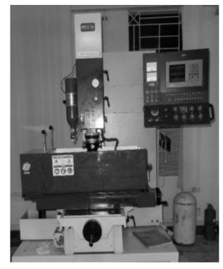
FIG. 1(a). ELECTRICAL DISCHARGE MACHINING
