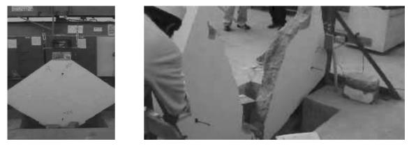
FIG. 16. PHOTOS SHOWING THE DIAGONAL COMPRESSION TESTING OF WALL-1 AT 28 DAYS
