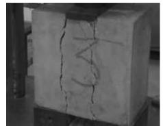
(d) TYPE-2, WITH PLASTER FIG. 8. SHEAR TESTING OF MASONRY TRIPLETS WITH ZERO LATERAL FORCE
