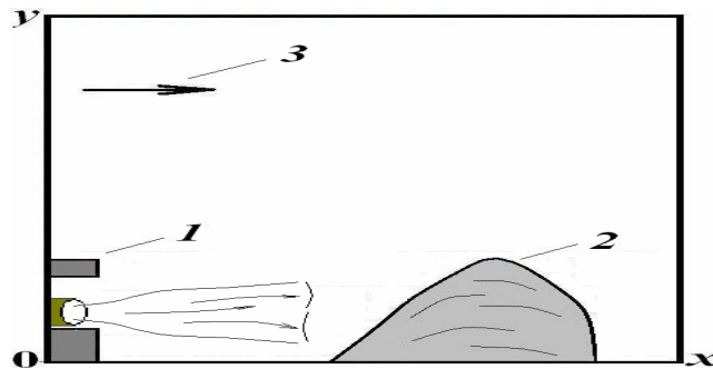
Рис.3. Схема расчетной области: 1 – хранилище твердого ракетного топлива; 2 – защитный вал; 3 – направление ветра
