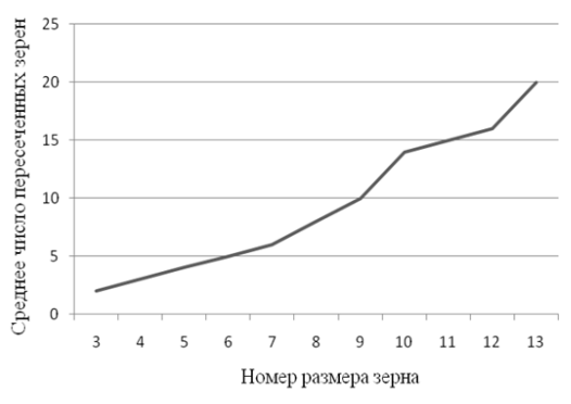
Рис. 5. Зависимость среднего числа пересеченных зерен от номера размера зерна
