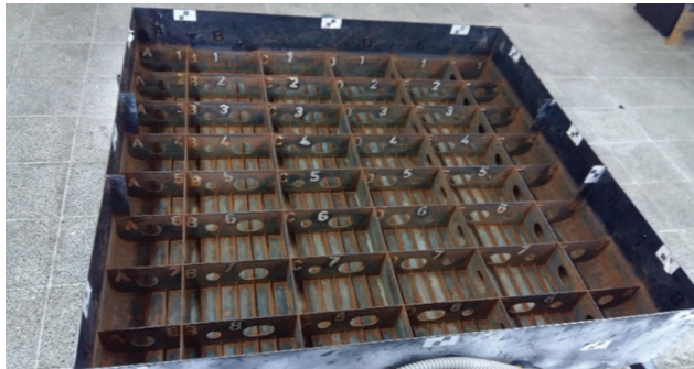
Şekil 2. Deney Sisteminde Kullanılan Balast Tankı Fiziksel Modeli
