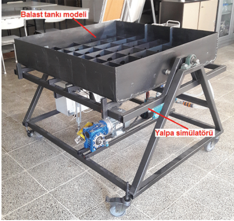
Şekil 3. Yalpa Simülâtörü ve Taşıyıcı Sehpa
