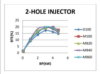
FIG -4: VARIATION OF BRAKE THERMAL EFFICIENCY WITH 2 NO OF HOLES
