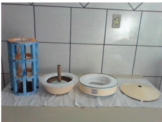
Figura 3- Maquete do reservatório elevado do pátio da ETA visto de forma compartimentada.
