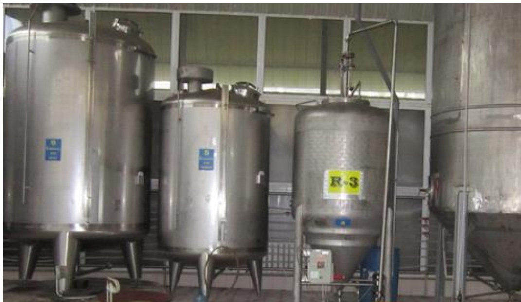
Рис. 3 Опытно-промышленный реактор R3 с местным щитом управления
