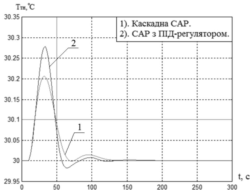
Рис. 4 – Результат порівняння традиційної САР і САР підвищеної динамічної точності за каналом регулювання температури теплоносія теплої підлоги шляхом зміни обертів приводу компресора ТН
