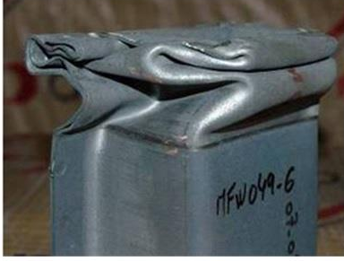
Şekil 1: Usibor 1500-Ductibor 500 kaynak bağlantısında darbe davranışını incelemek için yapılmış bir testin sonucu [14].
