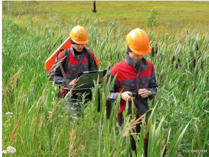
Фиг. 4. Обход от обслужващия персонал при диагностиране на тръбопровод с комплекс за магнитометрична диагностика
