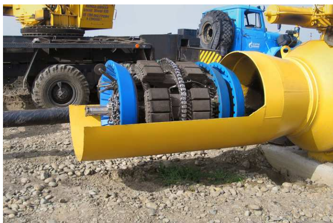
Фиг. 3. Приемна камера за запускане на вътретръбни инспекционни прибори
