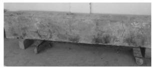
FIG. 4. CLAY BEAMS BAKED WITH THE TREATMENT OF PLASTIC SHEET COVER BEFORE BAKING
